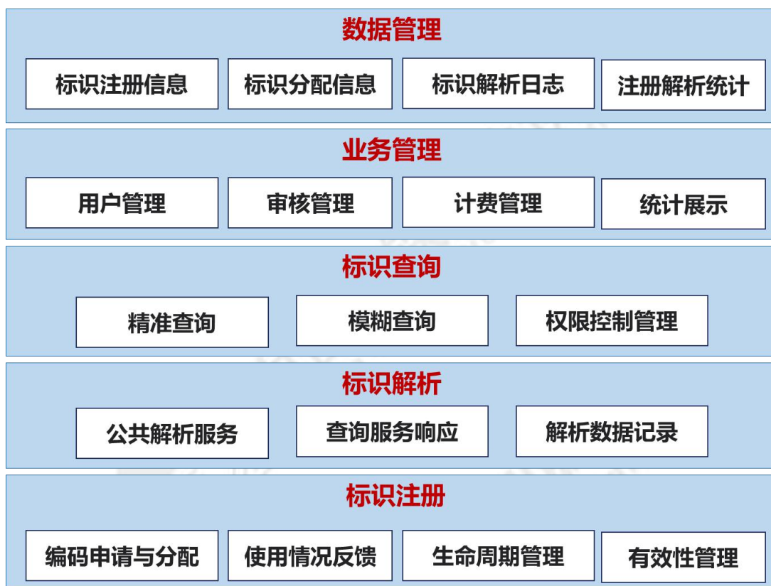
图 5-1 钢铁行业工业互联网标识解析功能架构
