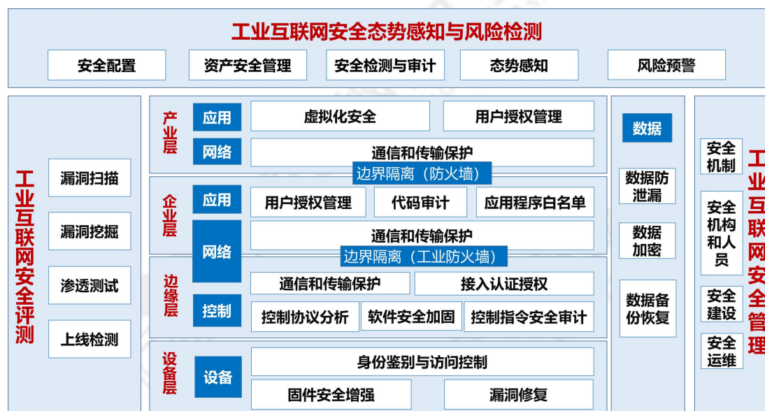
图 7-1 钢铁行业工业互联网安全功能架构
